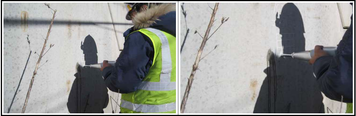
【그림 11.3.6】 슈미트해머를 이용한 반발경도시험 전경
